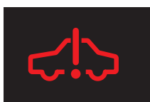
ハイブリッドシステム 異常警告灯
